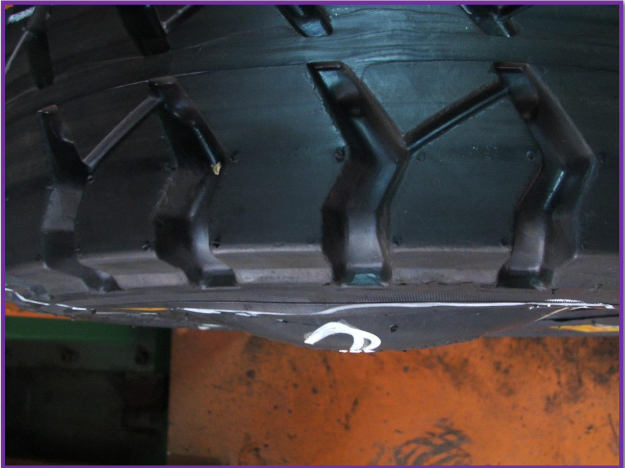
รูปที่ 3 ลักษณะการเสียหายจากการบวมแฉกของยางล้อตัน
