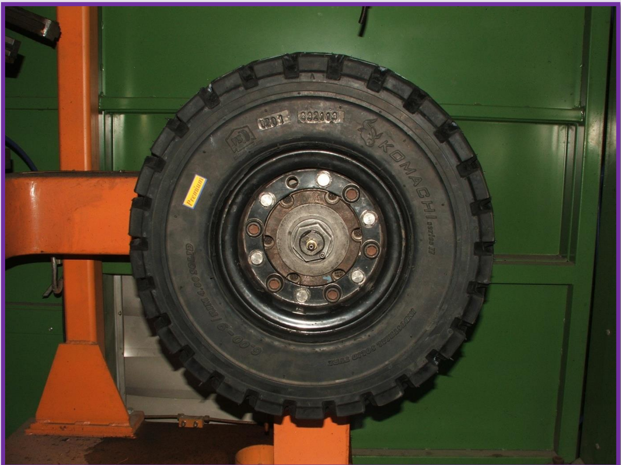
รูปที่ 2 ต้นแบบยางล้อตันถนนน้ำมันขนาด 7.00-12
